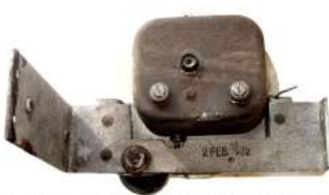
Drejekondensatoren er her udmonteret for reparation af fejlen med kortslutningen mellem rotor og stator, det kunne rettes ved at efterspænde de to skruer der holder kondensatorhuset på plads. Bemærk årstallet 2 FEB 1932
