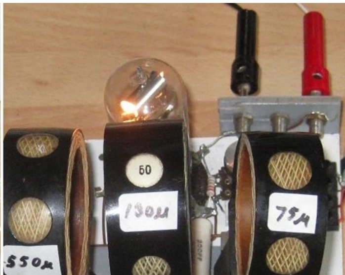
D 2 i funktion, bemærk lysstyrken fra glødetråden
